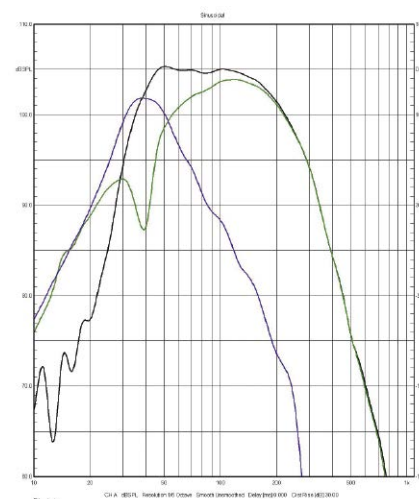
Rys. 6 CE1TX , charakterystyki źródeł niskich częstotliwości (poniżej 1 kHz, pomiar w polu bliskim).
